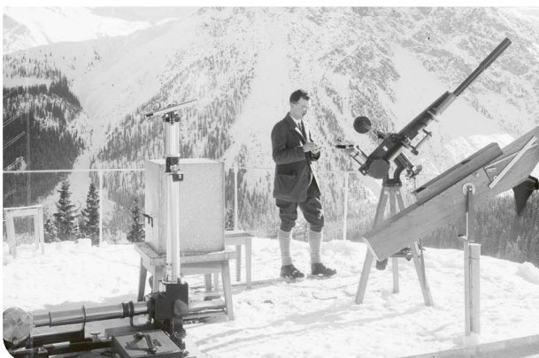
Abbildung 6: Daniel Chalonge, ein Forscherkollege von F. W. Paul Götz, auf der Terrasse des Hauses «Firnlicht» in Arosa in den frühen 1930er Jahren, zwischen dem Fabry-Buisson-Spektrophotometer (dem Vorläufer des Dobson-Spektralphotometers), dem Chalonge-Spektrografen und dem Féry-Spektrografen. Quelle: Fotoarchiv MeteoSchweiz
