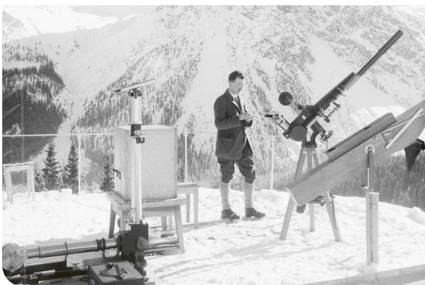
Figure 6 : Le Dr Daniel Chalonge, collègue de F.W. Paul Götz, sur la terrasse de la maison « Firnelicht » à Arosa au début des années 1930, entre les spectrographes Fabry-Buisson (précurseur du spectrophotomètre Dobson), Chalonge et Féry. Photo : auteur inconnu. Source : Archives photographiques de MétéoSuisse
