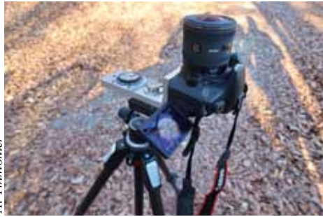
Abb. 2: Ausrüstung für die hemisphärische Fotografie, mit Fischaugenobjektiv, Stativ (inklusive 3-Achsen-Kopf) und Montageplatte (inklusive Kompass und Libelle).
